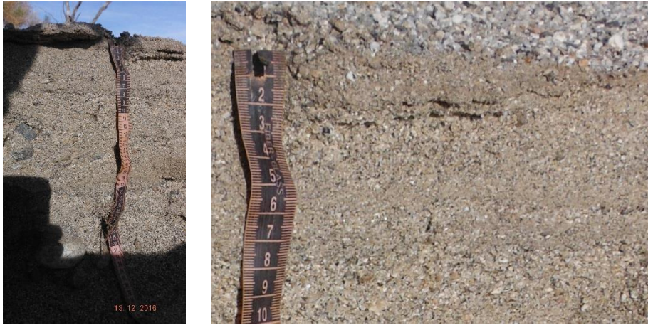
Foto V. 3 Suelos en la zona del proyecto, compuestos principalmente por arenas que los hacen altamente deleznable.
