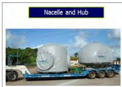
**Figura 13: Transporte de Nacelle y Hub**
