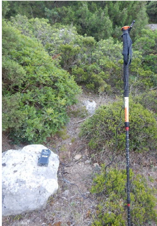
Photo 1 : Exemple de placement du détecteur d'ultrasons Batlogger M, avec microphone en hauteur
