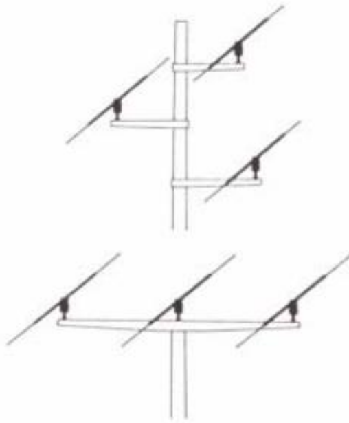
Figure 11-25 : Poteaux de puissance construits avec des isolateurs verticaux (évités)
