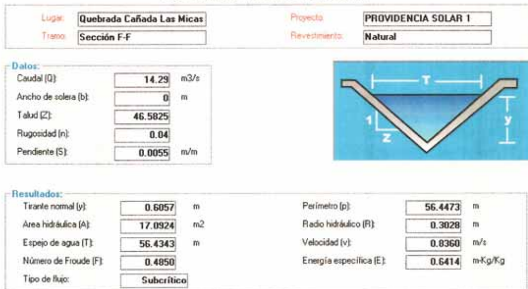
FIGURA IX-17 CÁLCULO DE LA CRECIDA MÁXIMA EN LA SECCIÓN F-F DEL CAUCE DE LA QUEBRADA CAÑADA LAS MICAS
