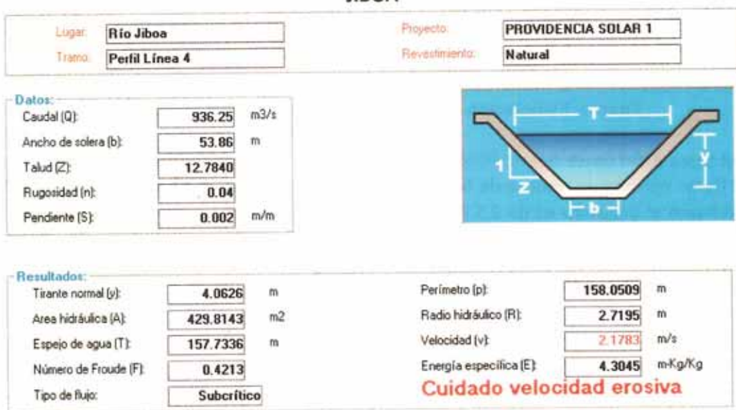
FIGURA IX-9 CÁLCULO DE LA CRECIDA MÁXIMA EN LA SECCIÓN LÍNEA 4 DEL CAUCE DEL RÍO JIBOA
