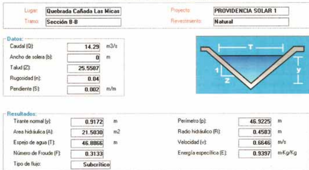
FIGURA IX-15 CÁLCULO DE LA CRECIDA MÁXIMA EN LA SECCIÓN B-B DEL CAUCE DE LA QUEBRADA CAÑADA LAS MICAS
