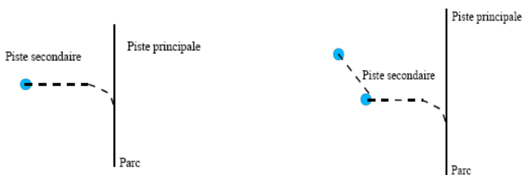
Figure 4 : Tracé idéal des pistes de débardage, tracé à l'avance en fonction des cartes d'inventaire d'exploitation (Source : Normes d'inventaire d'exploitation, juillet 2007)
