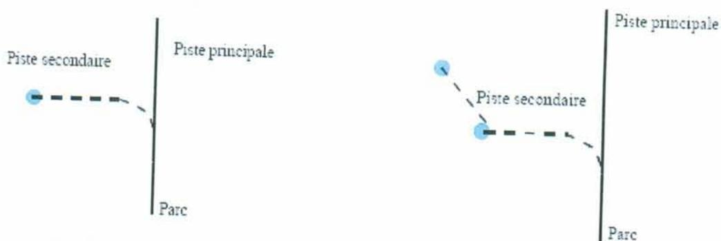
**Figure 5 : Tracé idéal des pistes de débarquement, tracé à l'avance en fonction des cartes d'inventaire d'exploitation (Source : FRM, Normes d'inventaire d'exploitation, juillet 2007)**
