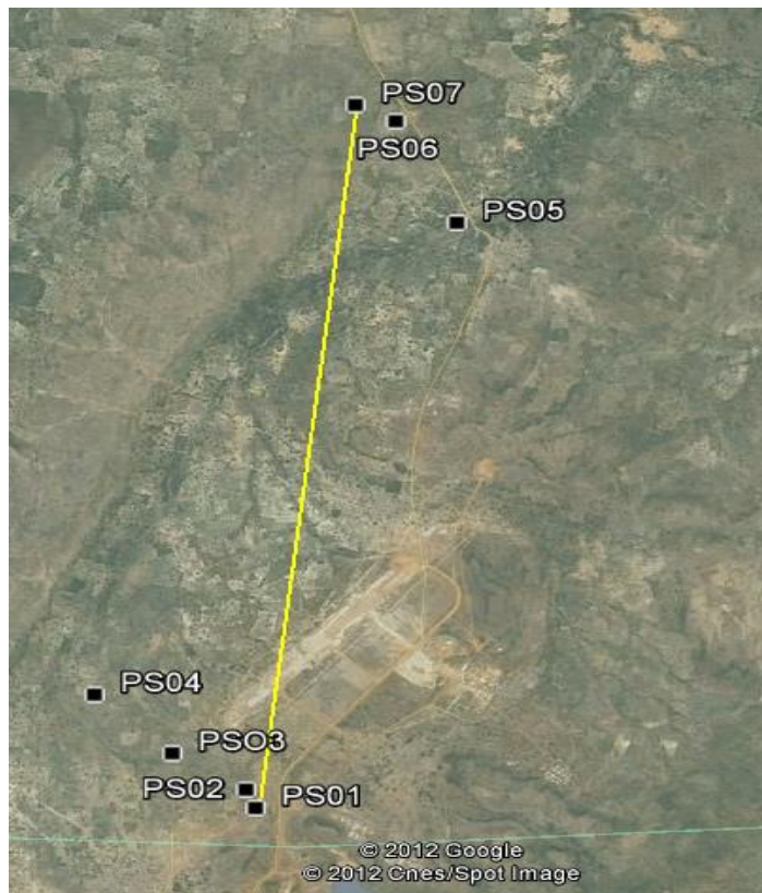
Figure 2 Variante 1 de la ligne de 33 kV
