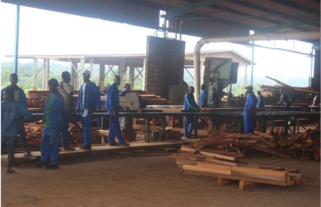
Photo 17 Réception des billons fondus et entiers à la scie horizontale
