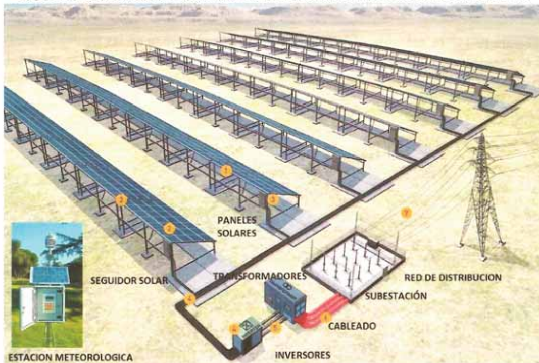
FIGURA IV-10 INFRAESTRUCTURA FÍSICA DE UNA PLANTA FOTOVOLTAICA TIPO
