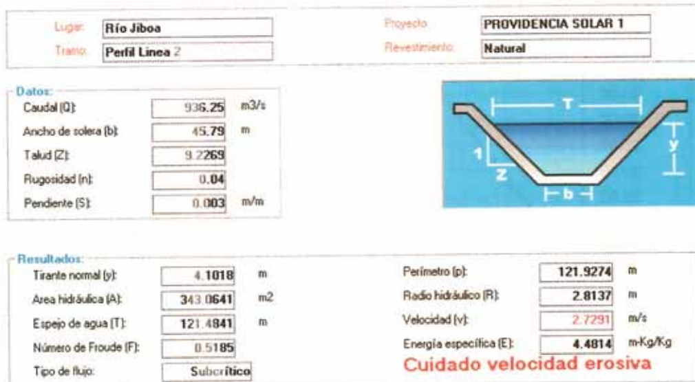
FIGURA IX-5 CÁLCULO I LA CRECIDA MÁXIMA EN LA SECCIÓN LÍNEA 2 DEL CAUCE DEL RÍO JIBOA
