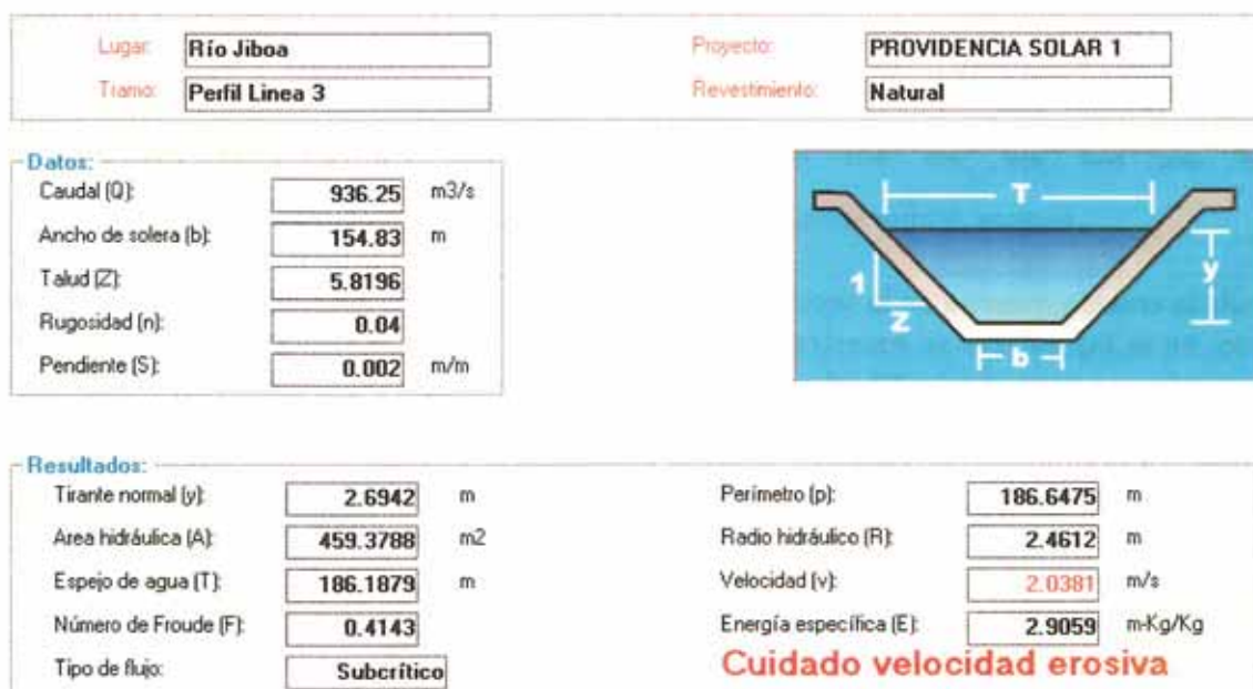
FIGURA IX-7 CÁLCULO DE LA CRECIDA MÁXIMA EN LA SECCIÓN LÍNEA 3 DEL CAUCE DEL RÍO JIBOA
