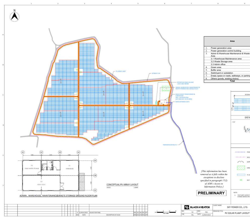
FIGURE 2.1-2: LAYOUT OF LAND USE OF THE SKY POWER SOLAR POWER PLANT PROJECT.
