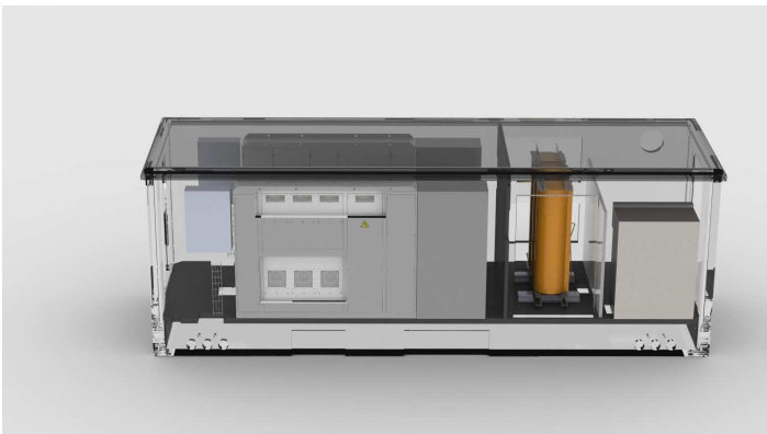
Disposición equipos dentro de la caseta
