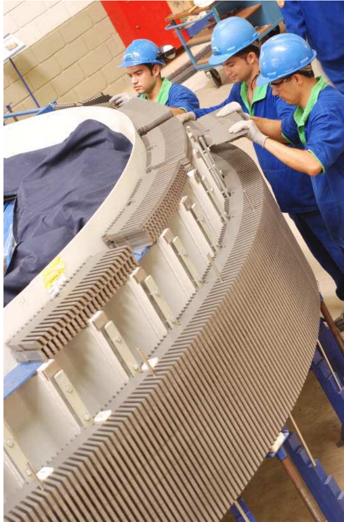
Figura 10 – Apilado de la chapa magnética
