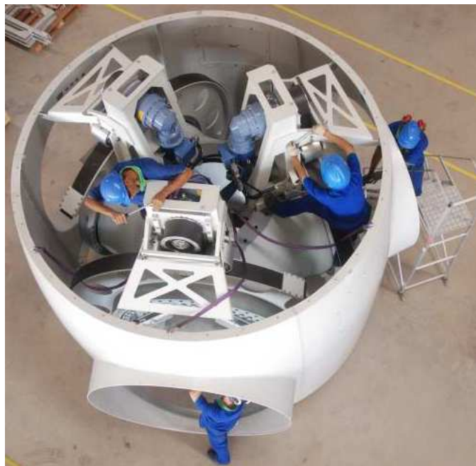
Figura 16 – Montaje del Sistema Pitch
