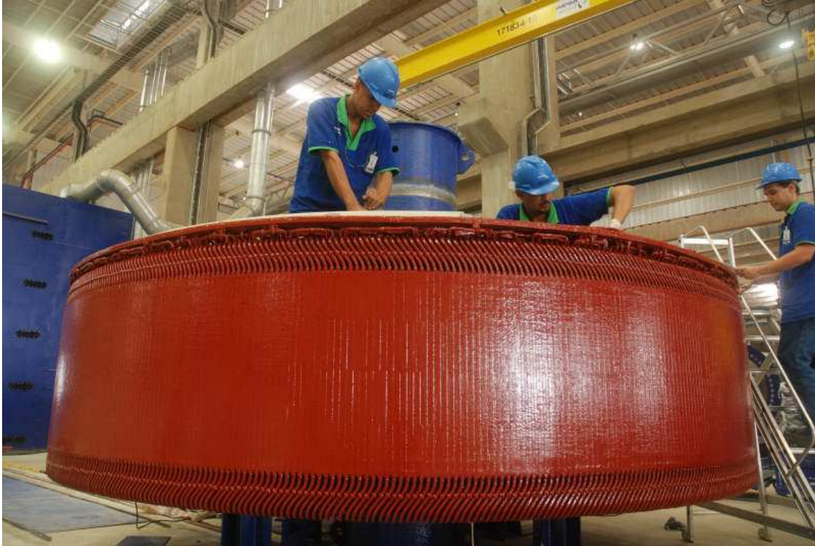
Figura 11 - Estator del Generador
