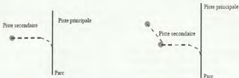
Figure 5 : Tracé idéal des pistes de débarbage, tracé à l'avance en fonction des cartes d'inventaire d'exploitation
